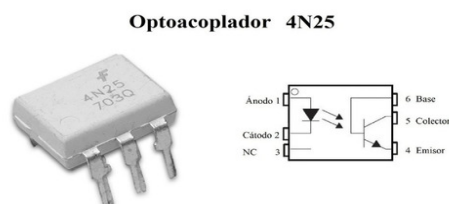
FIGURA 21. Estructura de optoacopladores.
