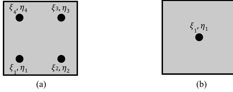
Figura 3: Elemento finito sólido de aproximación lineal (a) integración completa y (b) integración reducida.
