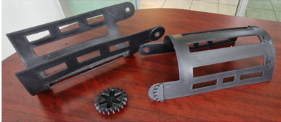
FIGURA 10. Conjunto de componentes del módulo de antebrazo del exoesqueleto fabricados por manufactura aditiva (impresión 3D). Fuente: Elaboración propia.
