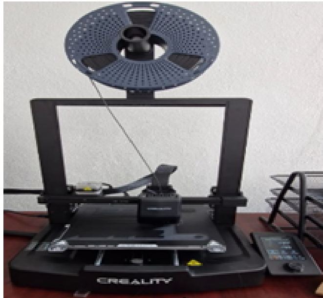
FIGURA 9. Impresión 3D del componente estructural del módulo de antebrazo del exoesqueleto durante la etapa de fabricación. Fuente: Elaboración propia.
