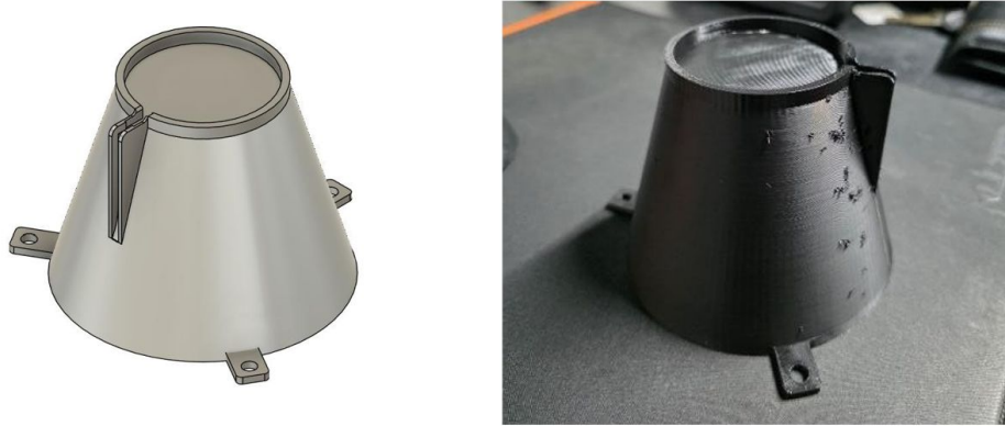
FIGURA 5. Modelo 3D y prototipo físico de la plataforma fabricado mediante impresión 3D con material PLA. Fuente: Elaboración propia.
