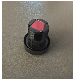
FIGURA 6. Filtro de Corte IR/UV Colocado en el Lente de la Cámara.
