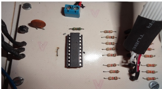
FIGURA 16. Construcción del circuito impreso del convertidor analógico digital (CAD). Fuente: Elaboración propia.
