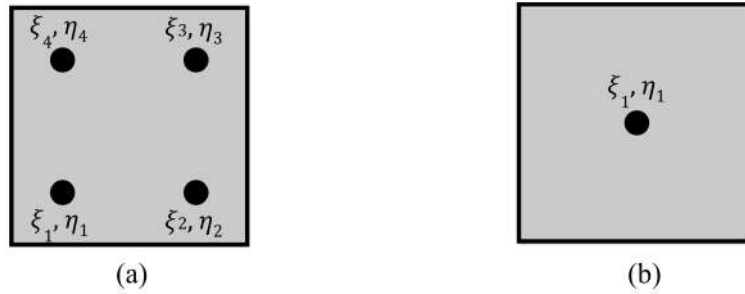
Figura 3: Elemento finito sólido de aproximación lineal (a) integración completa y (b) integración reducida.
